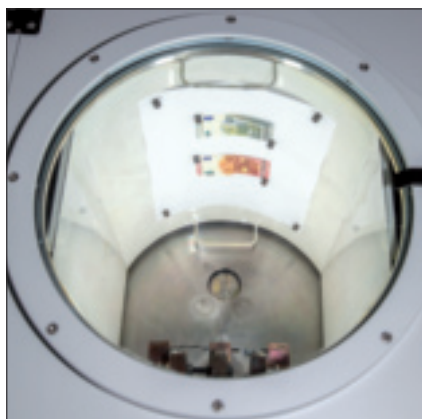
Hochvakuum-Metallbedampfungsanlage: Sichtbarmachung latenter Fingerspuren auf Geldscheinen
