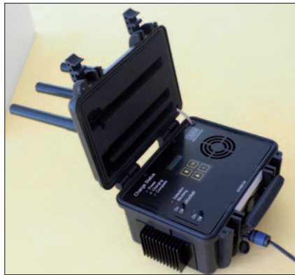
Haftraumüberwachungssystem: Detektion von Smartphones und Jamming
