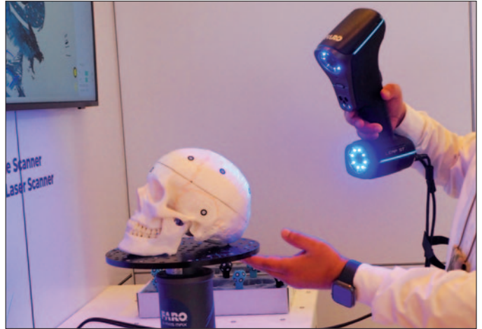
GPEC® digital: 3D-System für die Tatortarbeit; Erfassung eines Schädels mit einem 3D-Handscanner
