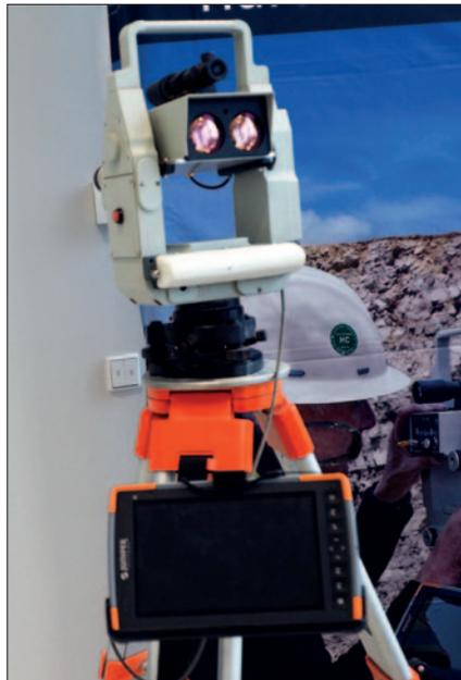
**Automatische 3D-Bruchwandvermessung mit Laserscanning**
