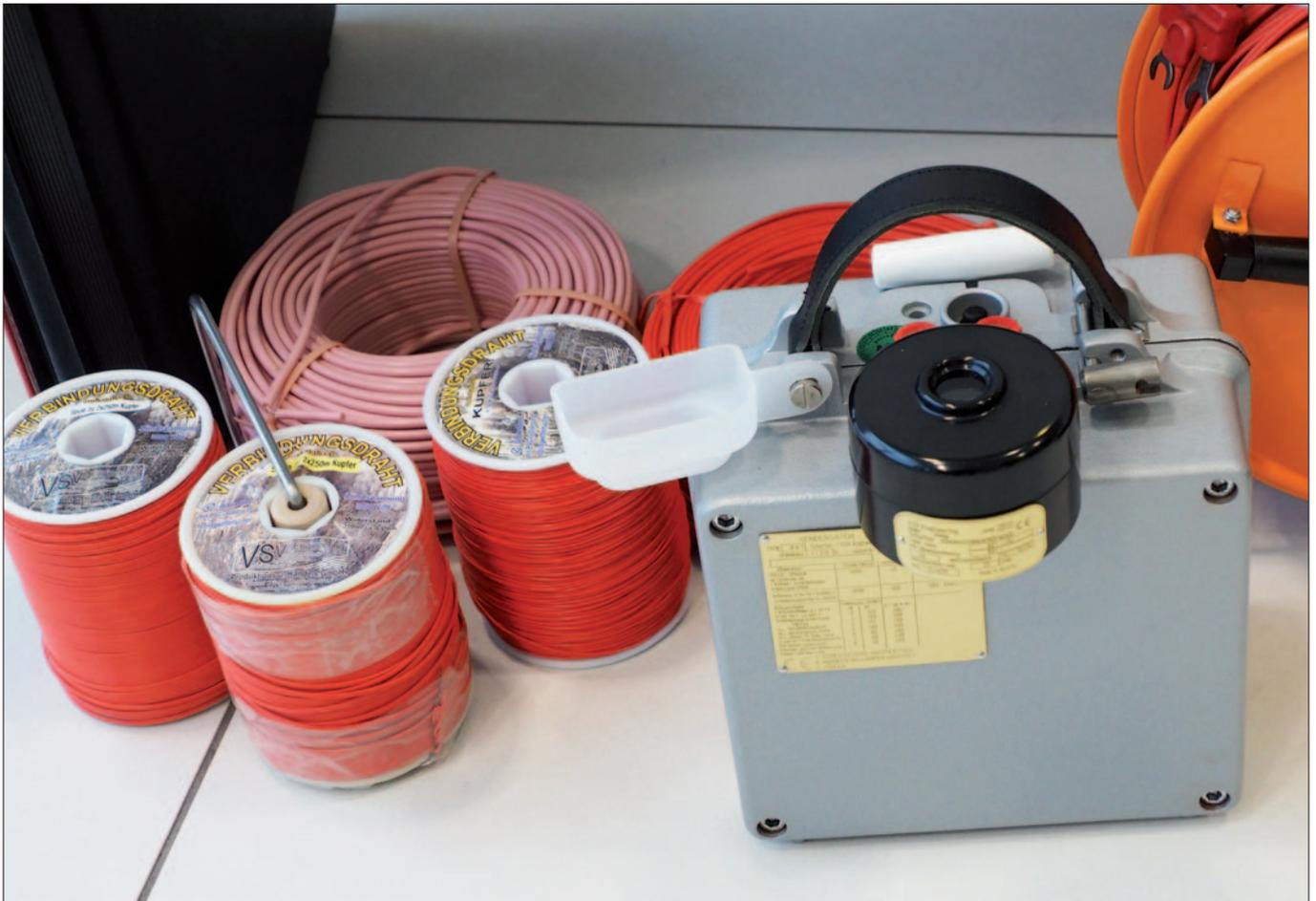
**Zündmaschine mit Prüfgerät, Verbindungsdrähten und Schießleitung**
