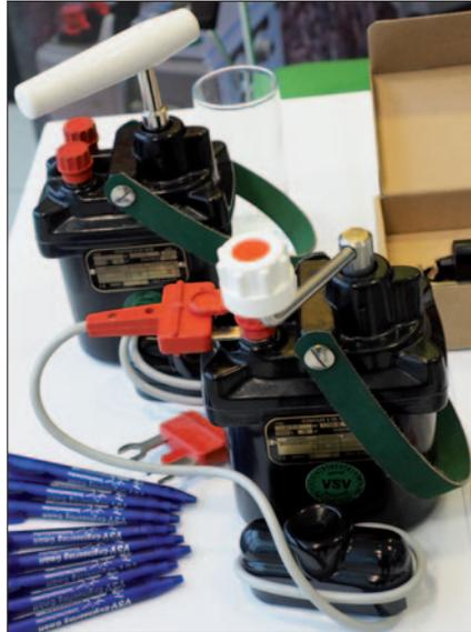
**Zündmaschinen mit Prüfgerät**
