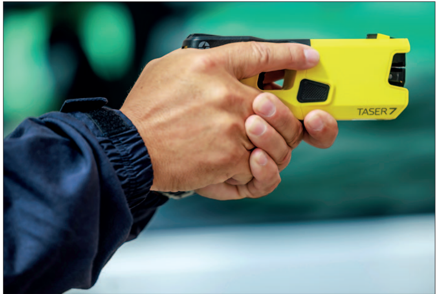
Die Taser X2 und T 7 besitzen ein Zweikartuschensystem. Beide Geräte beschleunigen die Geschosse mit komprimiertem Stickstoff über eine Entfernung von bis zu knapp 8 Metern
