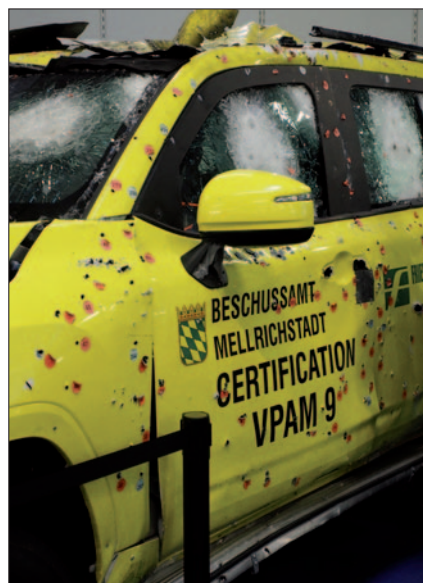
Beschusssicheres Kraftfahrzeug: Beschuss vermeintlicher Schwachstellen
