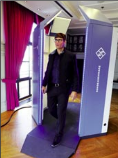
Ganzkörper-Scanner: berührungsloses Erkennen verdächtiger Gegenstände an einer durch den Scanner gehenden Person
