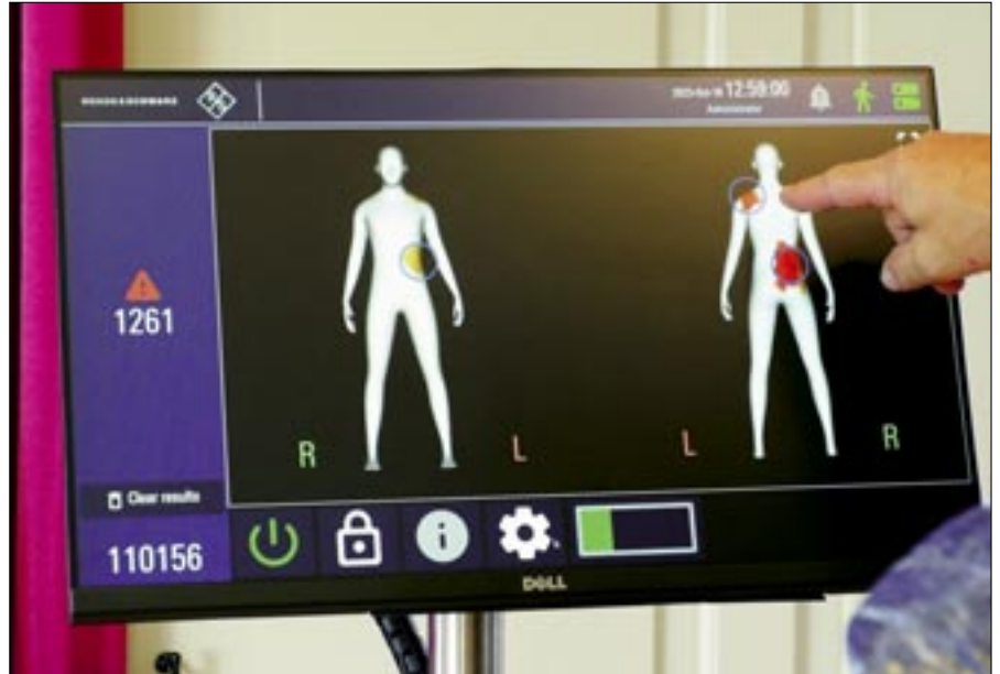
Ganzkörper-Scanner: berührungsloses Erkennen verdächtiger Gegenstände an einer durch den Scanner gehenden Person
