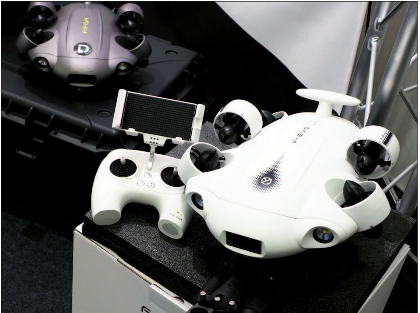
Tauchdrohne: Der Unterwasserroboter wird über eine Kabelverbindung gesteuert
