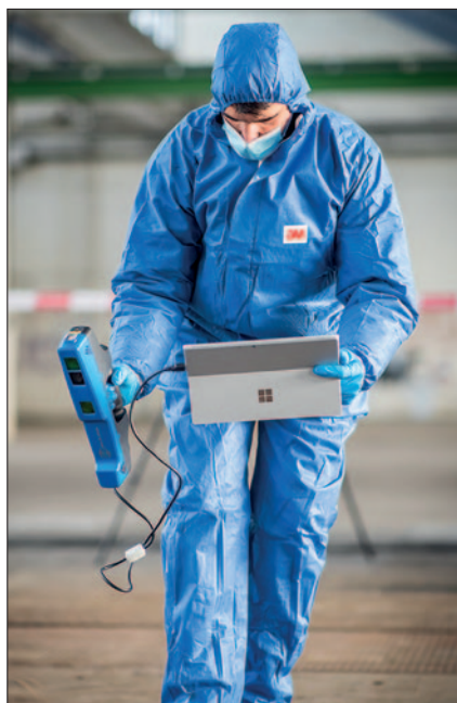
Hand-Laserscanner zur Erfassung eines Tatorts.
