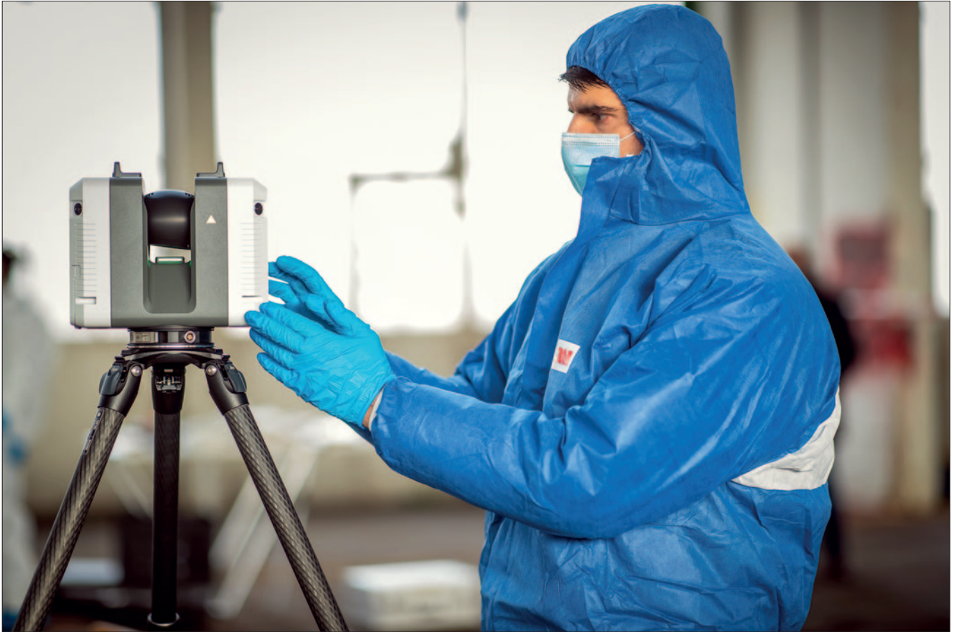
Laserscanner ermöglichen eine dreidimensionale Vermessung eines Tatortes.
