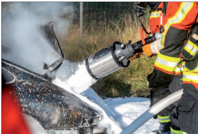
Fahrzeugbrand: Ist der Akku nicht betroffen, wird das E-Auto genauso wie ein Auto mit Verbrennungsmotor gelöscht.
