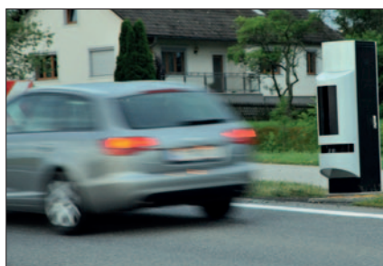
Section-Control-Anlagen messen die durchschnittliche Geschwindigkeit von Fahrzeugen innerhalb einer bestimmten Wegstrecke.
