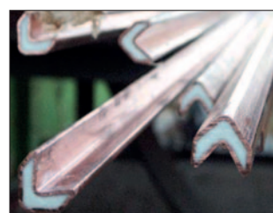
Mit speziell geformten Schneidladungen können Stahlträger durchtrennt werden.
