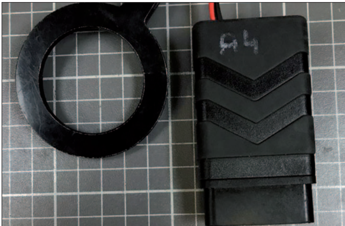
Kfz-Diebstahl: Ein OBD-Stecker mit Ringantenne ermöglicht eine Kommunikation zwischen der Bordelektronik und dem Smartphone. Über eine App werden Informationen ausgelesen, die für das Anlernen eines Schlüsselrohlings notwendig sind.
