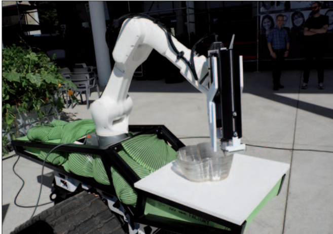
Wandering Factory: Raupenroboter mit 3D-Drucker.
