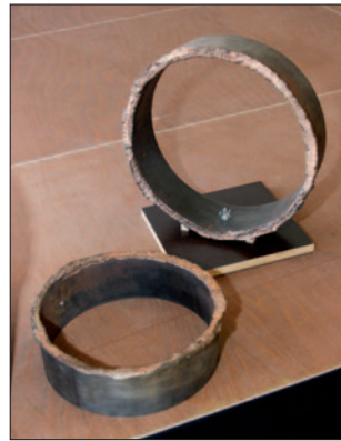
Metallsprengung mit einer Schneidladung.
