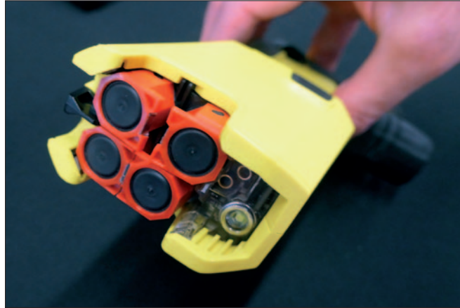
Taser 7: Pfeilspreizung verändert, kinetische Energie der Pfeile erhöht, Sichtbarkeit des Zielpunkts verbessert.
