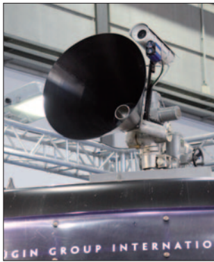
Distanzeinsatzmittel: Dreh- und schwenkbarer Schalltrichter, montiert auf dem Dach eines Fahrzeugs.
