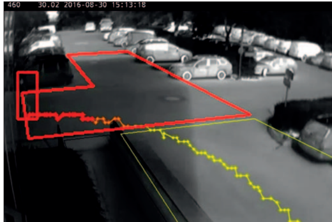
Das Überwachungssystem lernt Bewegungsmuster und Verhalten zu erkennen und den Gefährdungsgrad einzuschätzen.
