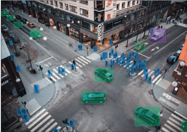
Objekterkennung: Objekte werden erkannt und nur als Textobjekt DSGVO-konform gespeichert.
