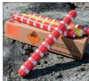
Emulsionssprengstoffe werden zum Sprengen von Gesteinen eingesetzt.
