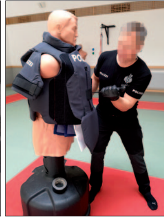
Test mit Schutzwesten der Polizei: Ballistische Gilets wurden nicht durchstochen.
