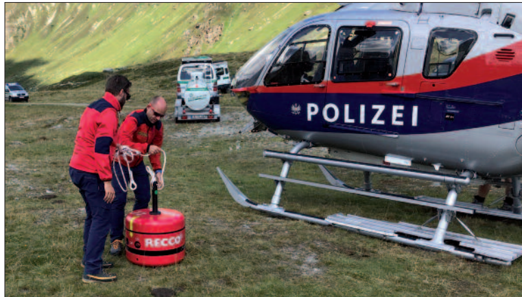
Personenortung: Der Recco-Detektor wird mit einem Seil am Hubschrauber angebracht.
