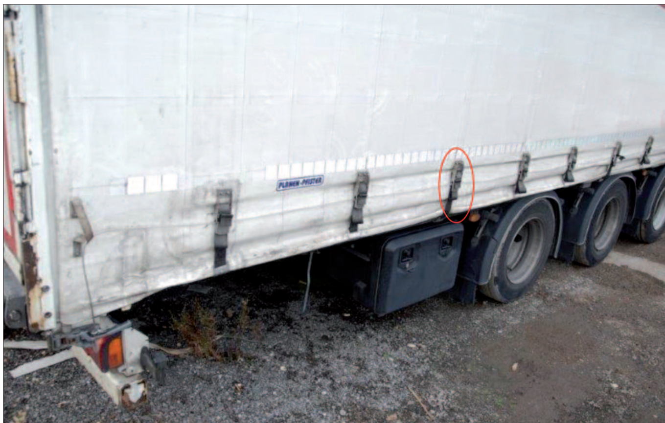
Frachtdiebstahl: Um die die Plombe nicht zu beschädigen, trennten die Täter das Stahlseil hinter der Planenverzurrung durch.
