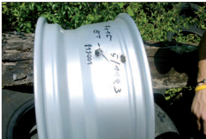
Waffengebrauchsanalyseverfahren: Ergebnis der Untersuchung eines Reifenbeschusses inklusive Felgendurchschusses.
