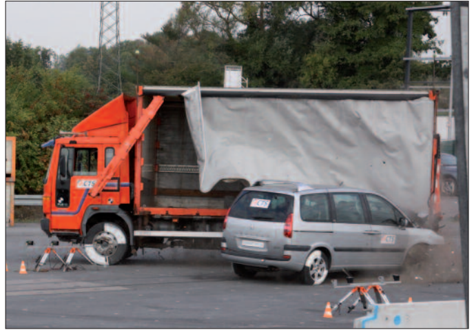
Crashtest (Pkw gegen quergestellten Lastwagen): Ein als Barriere abgestelltes Schwerfahrzeug bietet gegen einen Terrorangriff mit einem Pkw nur einen schlechten Schutz. Durch die hohe Geschwindigkeit des Pkws wird der Lastwagen weggeschoben.
