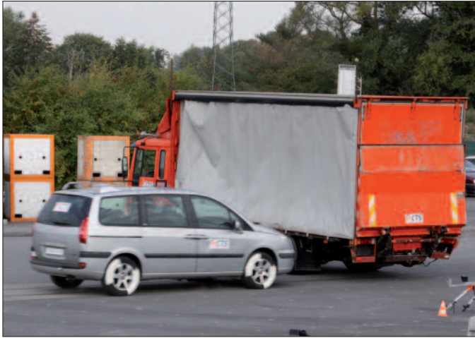
Crashtest (Pkw gegen quergestellten Lastwagen): Ein als Barriere abgestelltes Schwerfahrzeug bietet gegen einen Terrorangriff mit einem Pkw nur einen schlechten Schutz. Durch die hohe Geschwindigkeit des Pkws wird der Lastwagen weggeschoben.
