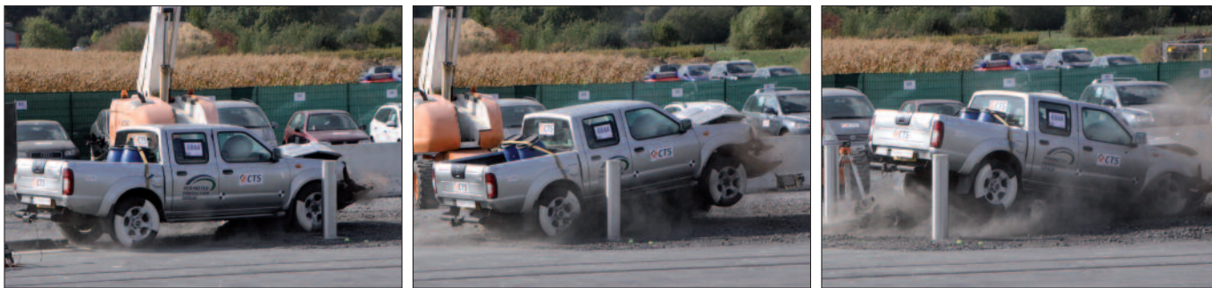
Crashtest (Pkw gegen Poller) auf dem Gelände der Firma Crashtest-Service.com (CTS) in Münster/Wolbeck: Für die Zertifizierung von Fahrzeugsperrern gibt es einige Normen.
