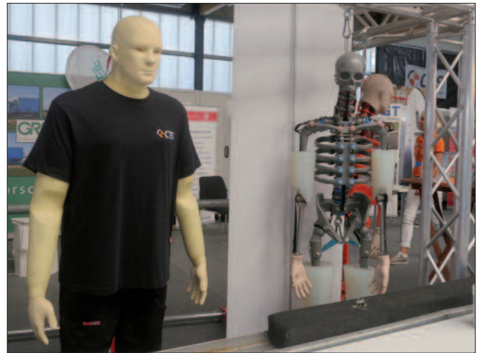
Spezielle Dummies für Crashtests.
