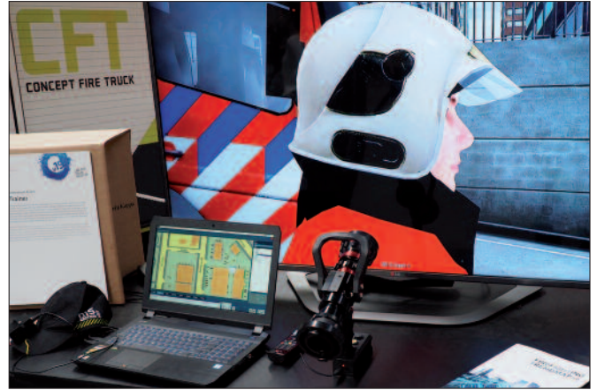
„Schlauchtrainer“ der Firma „Rosenbauer“: Simulation eines Löschangriffs in Innenräumen.
