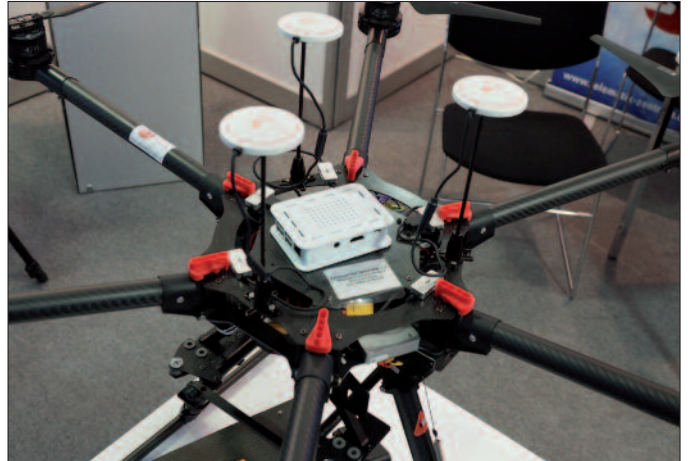
Lasercanner und Drohne zur 3-D-Vermessung: Erstellung von thermografischen 3D-Modellen von Gebäuden.
