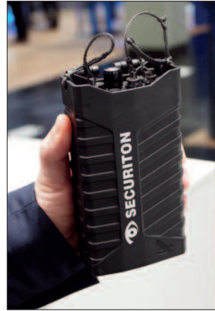
Tragbarer Drohnenmelder: Ortet Drohnensignale.
