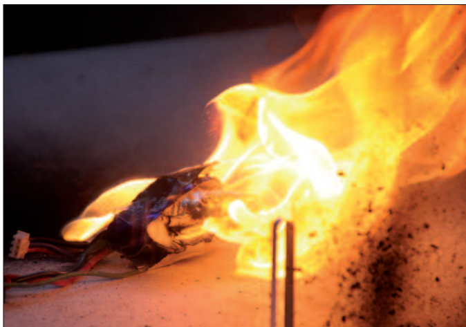
Brennender Lithium-Akku (Laden mit Überspannung); brennende Mehrfachsteckdose durch Überlastung.
