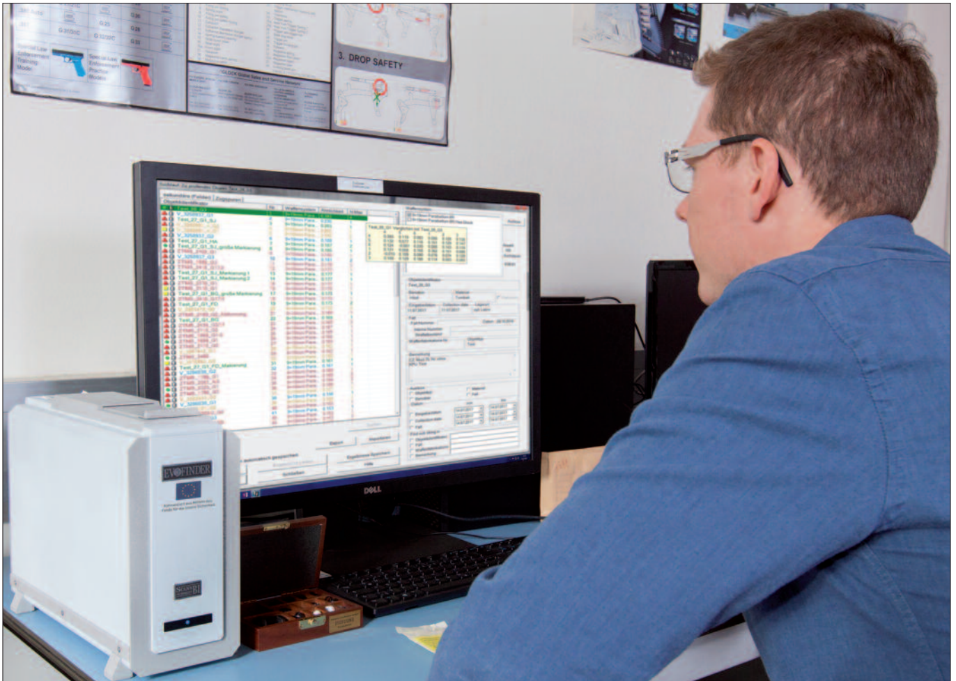
Kriminaltechniker beim Arbeiten mit dem EVO-Finder-Scanner, mit dem Geschoße und Patronenhülsen digitalisiert werden.
