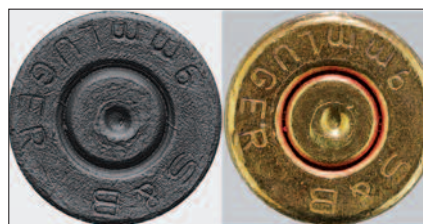
Links: Ergebnis des Scans mittels EVO-Finder; rechts die originale verfeuerte Patronenhülse.
