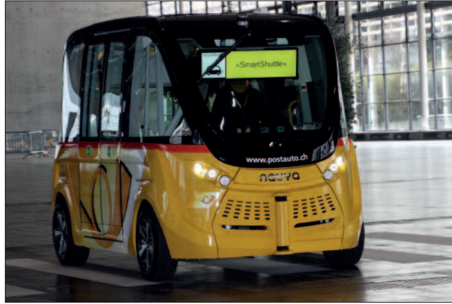
Autonom fahrender Bus der Schweizer Post: Er bietet Platz für elf Personen und fährt mit 20 km/h Höchstgeschwindigkeit.
