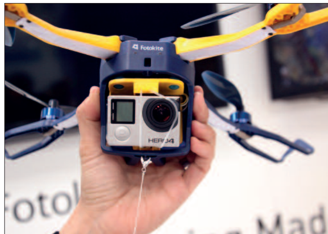
Quadrocopter mit Kamera: Das Gerät hängt an einem 30-Meter-Seil und liefert Videobilder.
