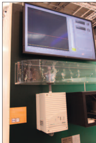
Ansaugrauchmelder: analysiert die angesaugten Gase.
