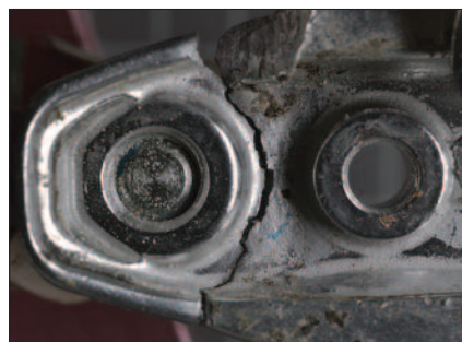
Passspur: Teile einer Motorradfußbraste. Der linke Teil stammt vom Tatort eines Einbruchs.
