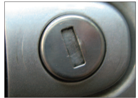
Ziehfix-Angriff auf Pkw-Schloss: Kreisrunde Spuren des Widerlagers.
