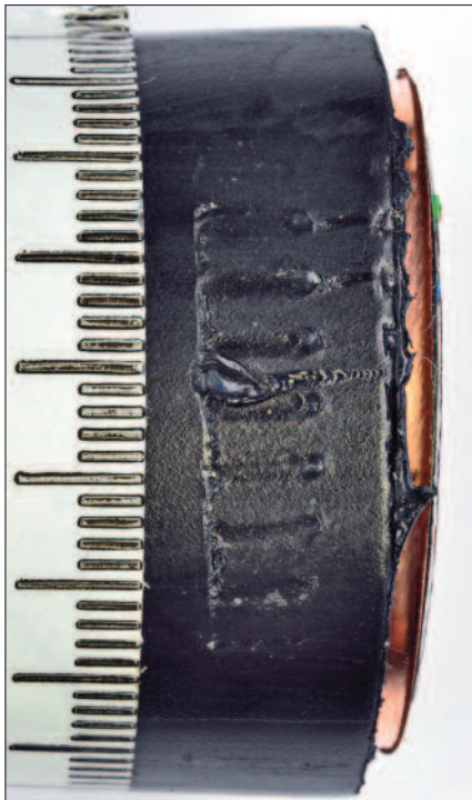
Kupferkabel: Mit Astschere durchtrennt; von der Polizei bei Buntmetall-diebstahl sichergestellt.
