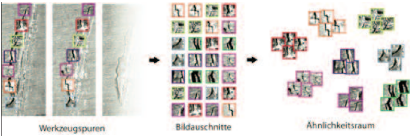
Deep-Learning-Verfahren: Werkzeugspuren werden in Bildausschnitte unterteilt, ähnliche Strukturen werden gruppiert.
