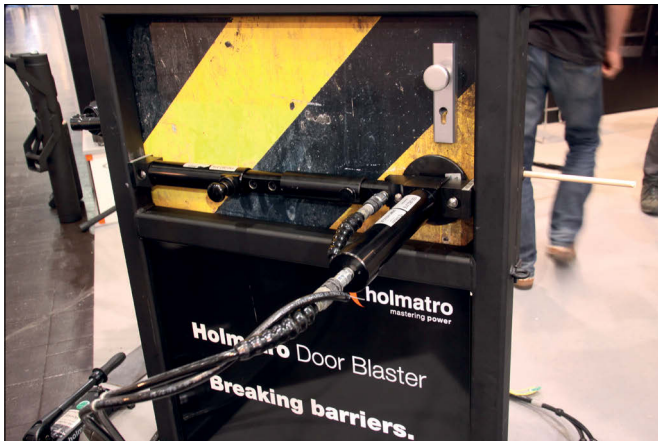
„Door Blaster“: Gerät zum raschen Aufbrechen stark gesicherter, nach innen aufgehender Türen.
