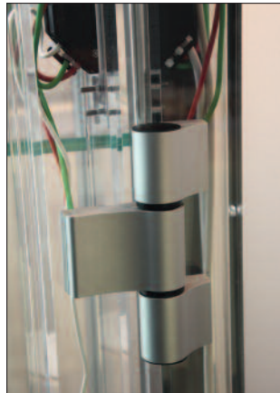
Zutrittskontrolle: Der Strom wird induktiv über das Türband-Scharnier übertragen.
