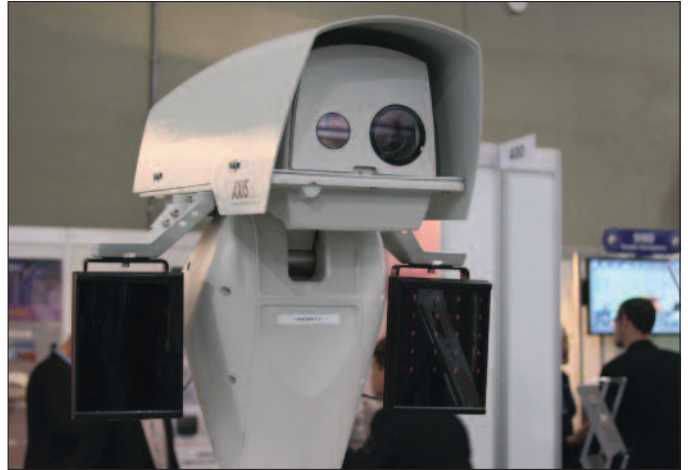
Freigeländesicherung: Sicherheitszaunsystem; optische und Wärmebildkamera mit Schwenk-/Neige-Zoom.
