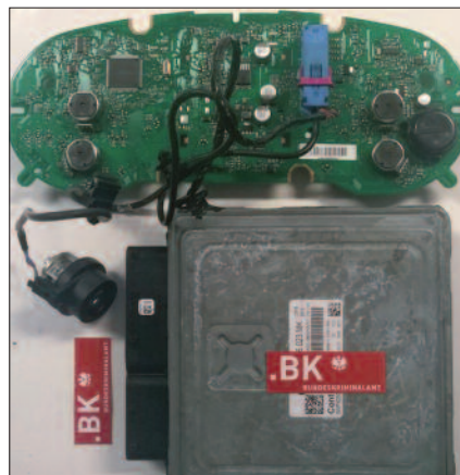
Steuerungsgerät: Speicherung von Informationen über Fahrzeug und Betrieb.
