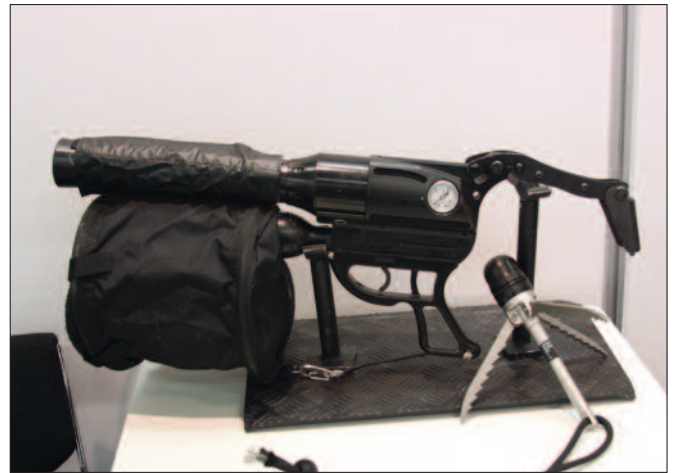
Hakenschießgerät: verschießt mit Druckluft Haken oder flexible Leitern bis in eine Höhe von 50 Metern.
