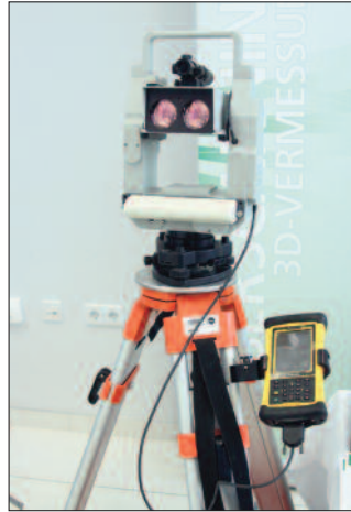
Sprengtechnik: Zündmaschine, Vermessung einer Bruchwand mit Laserscanner und GPS, Sprengzubehör.
