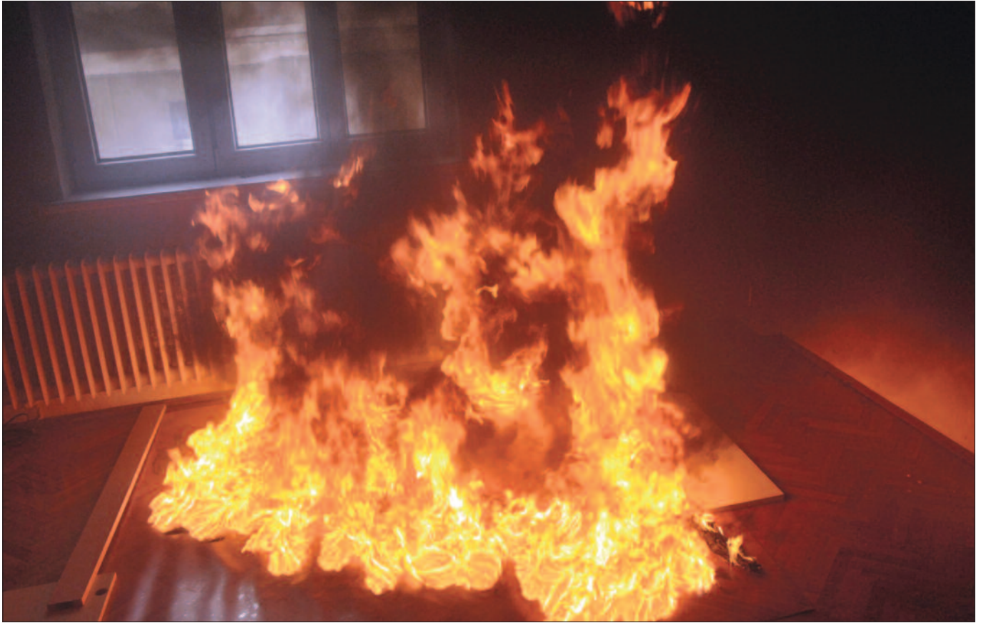
Benzin auf Kunststoffboden: Brandversuch des Landeskriminalamts Niederösterreich bei einem Seminar für Brandermittler.
