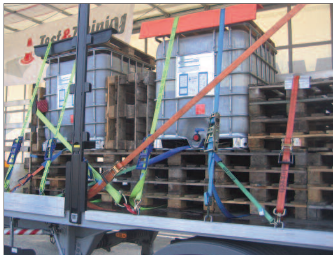
Richtige Beladung eines Lkws: Der Anordnungsbefugte hat dafür zu sorgen, dass die Vorschriften hinsichtlich des höchstzulässigen Gesamtgewichtes, der höchstzulässigen Achslasten und die Breite des Lkws eingehalten werden.
