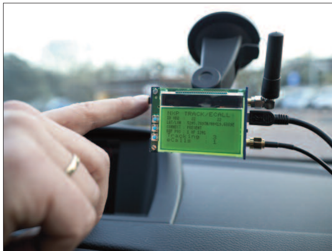
E-Call: Alle neuen Pkws sollen ab Oktober 2015 mit dem automatischen Notrufsystem ausgerüstet werden.
