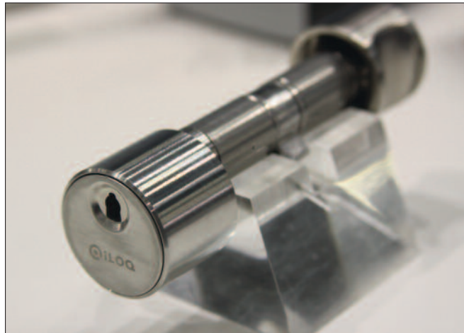
Digitale Schließanlage: Die Energie wird durch das Einführen des Schlüssels in den Zylinder erzeugt.
