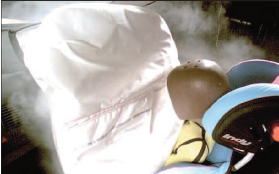
Schmouchspuren von Airbags ermöglichen es festzustellen, ob jemand ein Unfallfahrzeug gelenkt hat.
