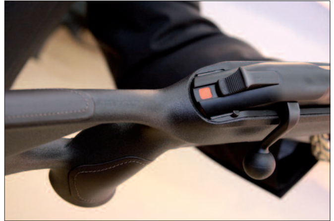
Repetierbüchse: Das Spannen/Entspannen wird über einen schwenkbaren Spannhebel bewirkt.
