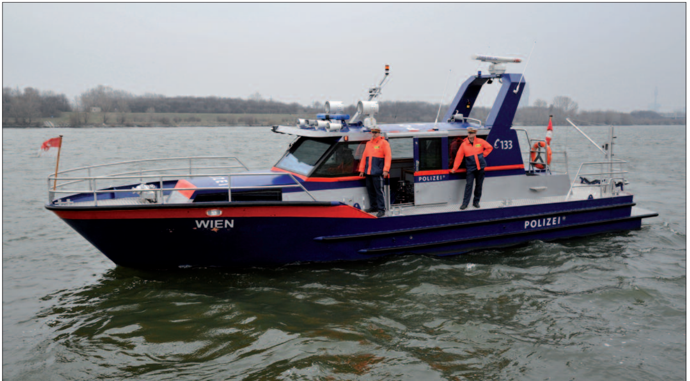
Polizeiboot „Wien“: Die Kabine kann abgeschottet werden, damit die Polizisten auch in kontaminierte Bereiche fahren können.
