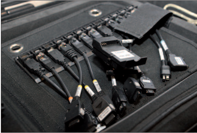
Mobile Geräte: Verbindungskabel zur Datenentnahme für die verschiedenen Schnittstellen.
