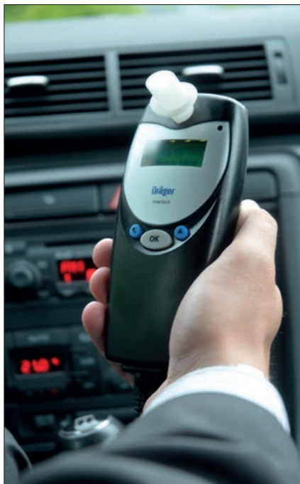
Alkolock: Das System verhindert die Inbetriebnahme eines Kraftfahrzeugs durch alkoholisierte Lenker.
