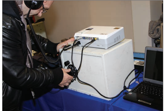
Öffnungstechnik für Tresore: Das Gerät wählt automatisch verschiedene Nummernkombinationen durch.
