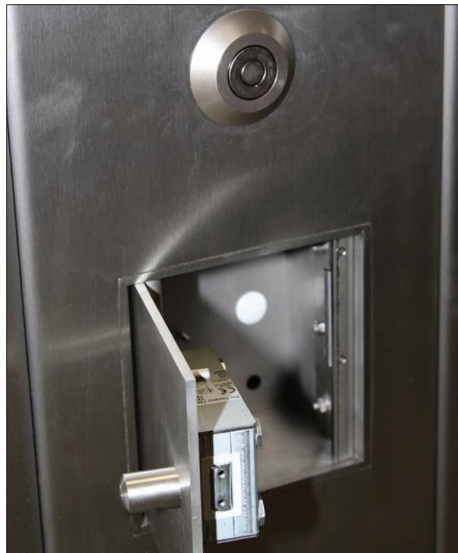
Elektronisches Schließsystem: Ein Transponder steht mit einer Auswerteeinheit im Inneren in Verbindung.
