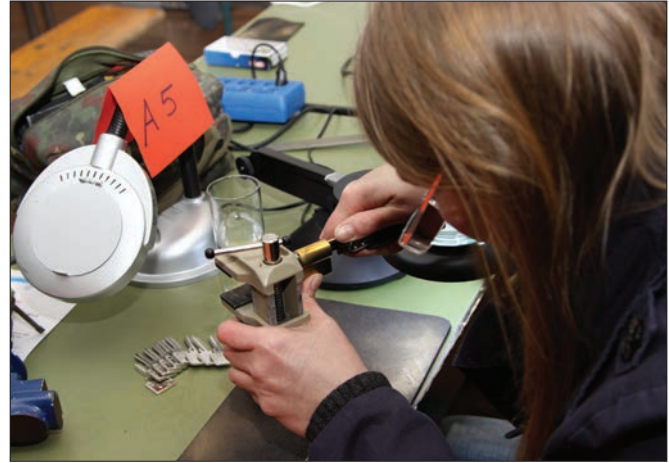
Sperrsport: Aus einem Rohling muss in möglichst kurzer Zeit ein funktionsfähiger Schlüssel gefeilt werden.
