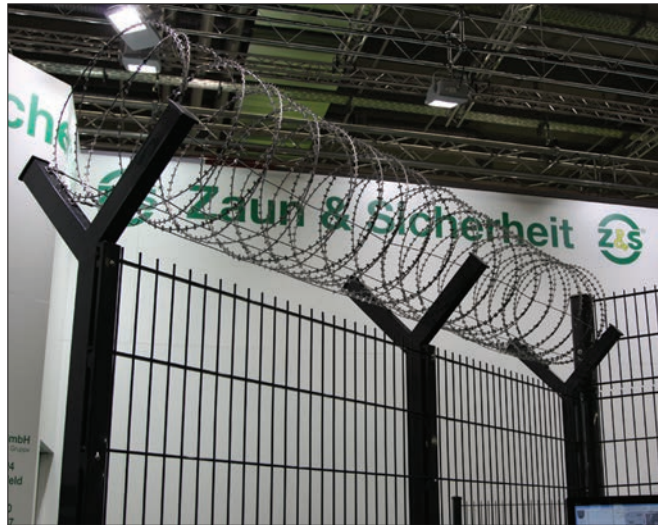
Ein Zaun als Barriere soll mindestens 2,5 Meter hoch sein, mit Pfosten im Abstand bis zu drei Metern.
