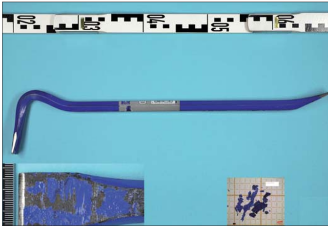
Geißfuß, vielfach verwendetes Einbruchswerkzeug, hinterlässt oft Lackabrieb am Tatort.
