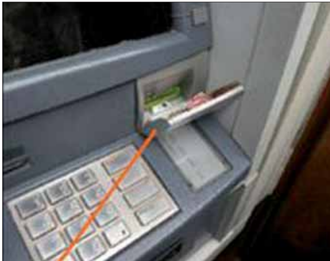
Skimming: Mit speziellen Vorbauten werden die Kartendaten vom Magnetstreifen ausgelesen.
